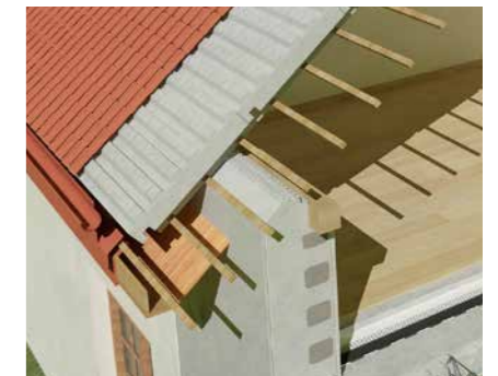
Схема соединения плиты крыши Изодом со стеной.
