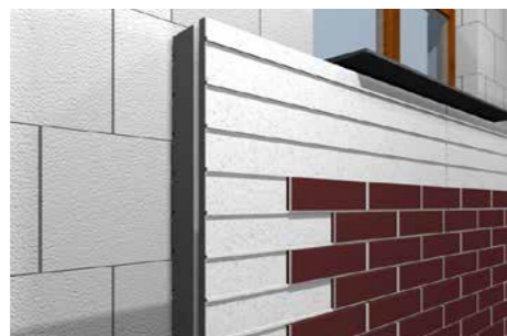
Схема работы панели IZOALFA
