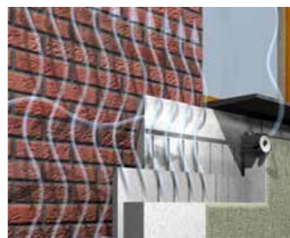
Die Platte IZOBETA dämmt wärmemäßig und trocknet die Wände des Gebäudes.
