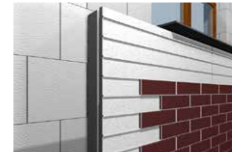
Funktionsschema der Platte IZOALFA
