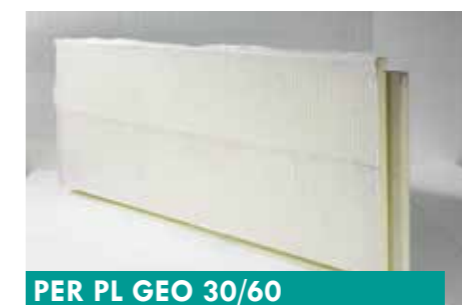
PER PL 30/60 Perimeter-Platte ohne Geotextil, Dichte 30g/l, 195x95x6 cm; erhältlich auch in den Dicken: 8, 10, 12 cm
