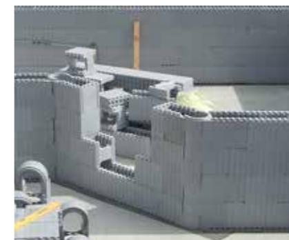
Anwendung von Scharnierelementen für die Gestaltung von Eckstücken unter einem beliebigen Winkel
