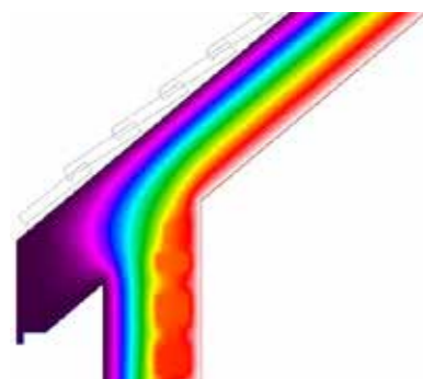
L'illustration présente une très bonne protection thermique, qu'assure l'utilisation des éléments MP pour la construction de la paroi coudée. La continuité de la couche d'isolation protège le bâtiment contre les pertes de chaleur et l'humidité.
