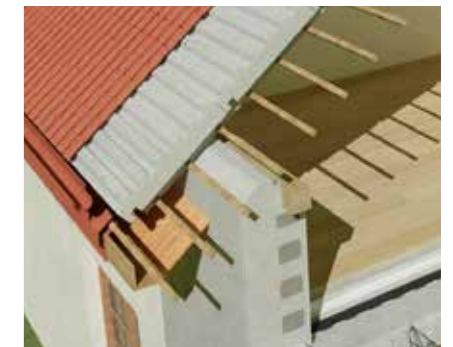
Schéma de jonction de la dalle de toiture Izodom avec le mur.
