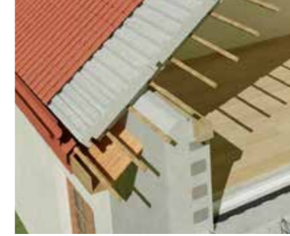
رسم تخطيطي يوضح ربط لوح الأسطح العلوية لإيزودوم مع الجدار.
