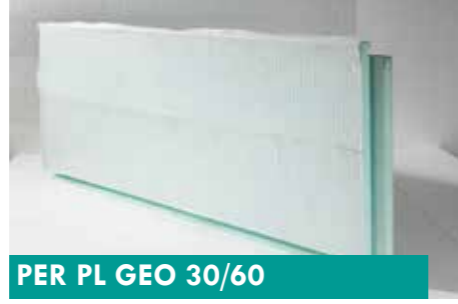
ألواح محيط الحدود الخارجية مع النسيج الأرضي، بكثافة 30 غم/لتر، 195x95x6 سم؛ متوفرة أيضاً بسمكات أخرى: 8، 10، 12 سم
