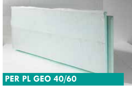
ألواح محيط الحدود الخارجية مع النسيج الأرضي، بكثافة 40 غم/لتر، 195x95x6 سم؛ متوفرة أيضاً بسمكات أخرى: 8، 10، 12 سم
