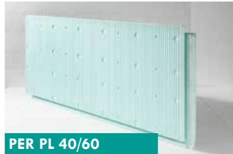
ألواح محيط الحدود الخارجية مع/أو بدون النسيج الأرضي، الكثافة 40 غم/لتر، 195x95x6 سم؛ متوفرة أيضاً بسمكات أخرى: 8، 10، 12 سم
