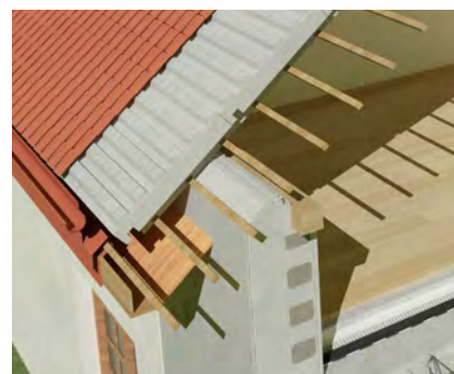
Esquema de la conexión la placa de techo Izodom con la pared.
