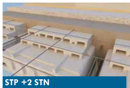
STP Spannweite: < 5,5 m, Höhe: 25 cm Betonverbrauch: 70 \text{ l/m}^2
