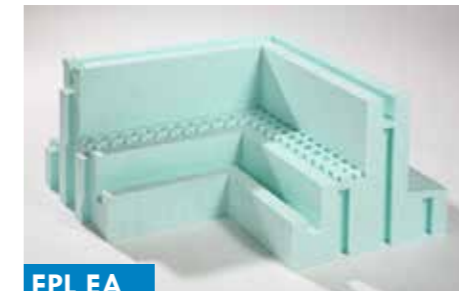
FPL EA Eckstück der Fundamentplatte, außen (80+80)x50x55 cm
